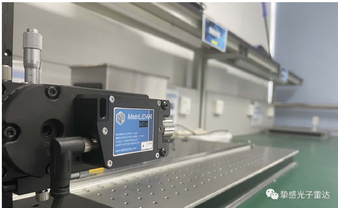
图 2 MD 系列传感器绝对距离测试
